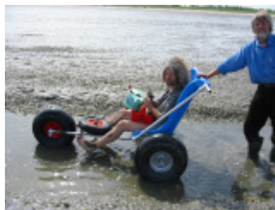
Erprobung von unterschiedlichen Radvarianten
